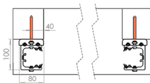
Vue de dessus avec poteaux
